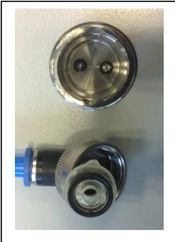
**Achtung :** Beim Aufsetzen des Entleerungsschlauchs auf das Ventilunterteil, achten Sie bitte auf die richtige Positionierung der Nocken des Ventilöffners, diese sind unterschiedlich groß und passen nur in einer Lage auf das Ventilunterteil
