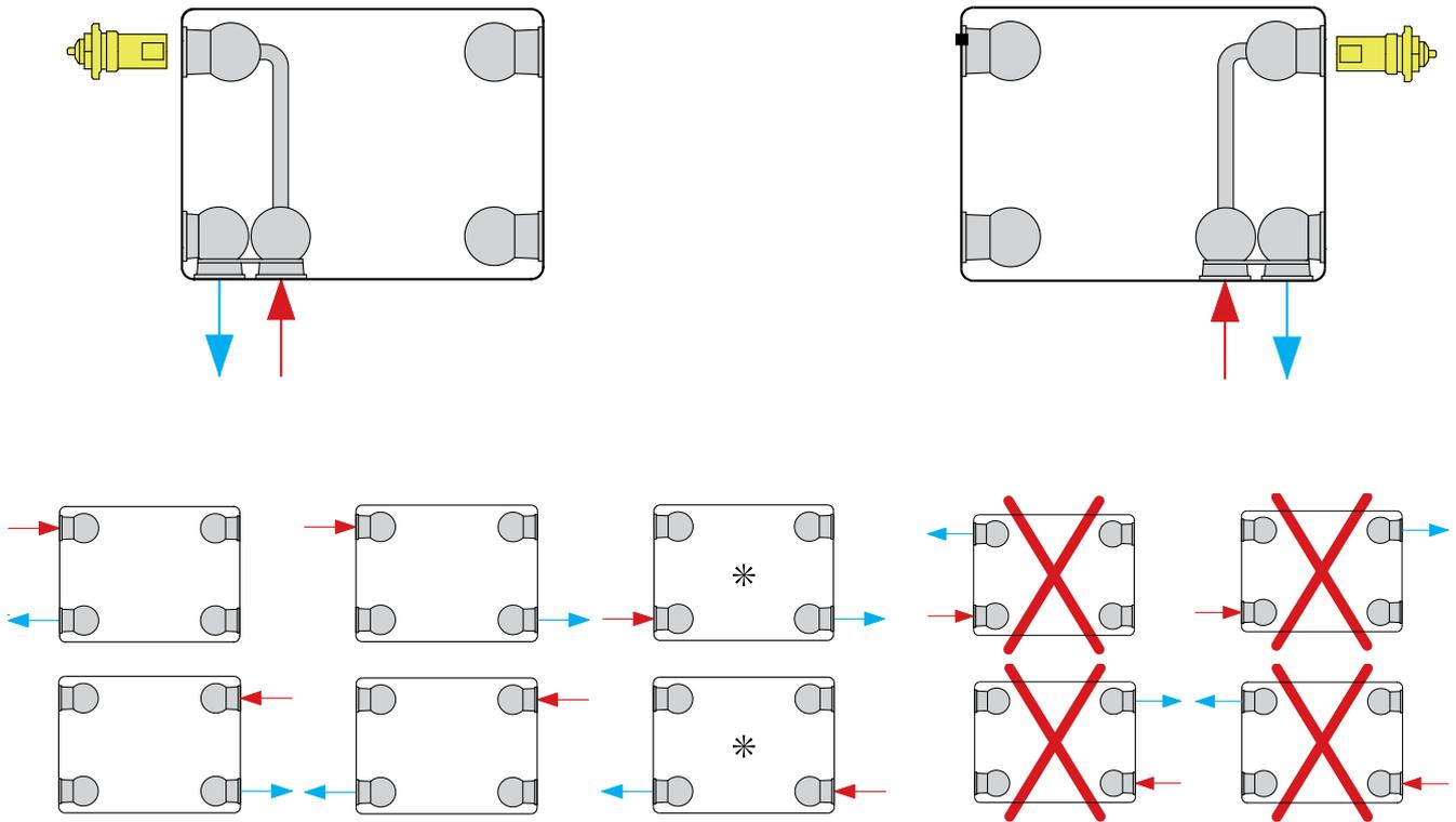
Bei Montage der Ventil-Fertigheizkörper als Compact-Heizkörper ist das eingebaute Ventilunterteil entfernt worden.
