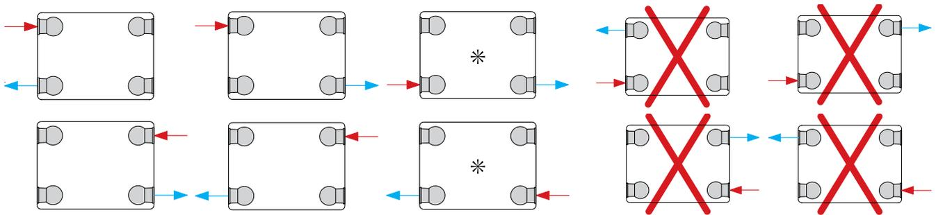
Pour ces modes de raccordement, il faut retirer la vanne et remplacer les bouchons en plastique par des bouchons en laiton.
