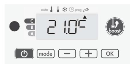
Erhöhen Sie die vom Umgebungstemperatursensor gemessene Temperatur um 2°C, indem Sie **[+]**.
