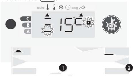
Wenn Sie die Einstellungen nicht ändern möchten, drücken Sie **OK**: das Gerät springt automatisch zur Einstellung des Höchstwerts. Um die Anwendereinstellungen zu verlassen, drücken Sie zweimal **mode**.
