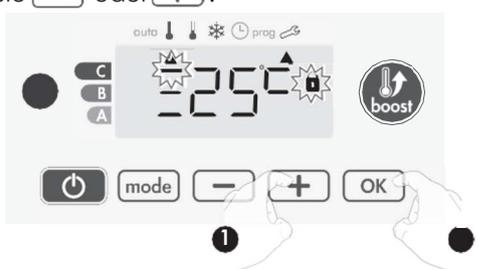
Zum Speichern und automatischen Weitergehen zur nächsten Einstellung drücken Sie **OK**. Um die Anwendereinstellungen zu verlassen, drücken Sie zweimal **mode**.
