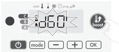
In der ersten Minute können Sie die Dauer des Boostbetriebs von 0 auf die maximal zulässige Dauer des Boostbetriebs erhöhen, wie in den erweiterten Einstellungen definiert. Die Einstellung erfolgt in Intervallen von 5 Minuten (zum schnelleren Umschalten, die Taste mindestens 2 Sekunden gedrückt halten) durch Drücken von und . Diese Änderung wird gespeichert und beim nächsten Boost wirksam.
