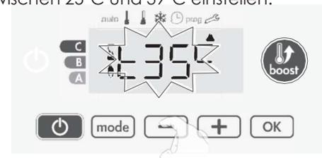
13- Zum Speichern und automatischen Weitergehen zur nächsten Einstellung drücken Sie **OK**. Um die Anwendereinstellungen zu verlassen, drücken Sie zweimal **mode**.
