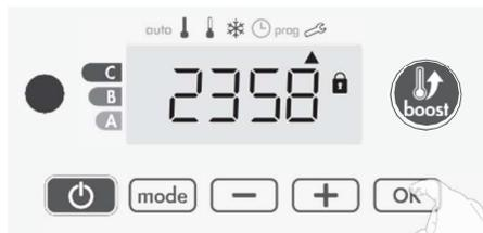
4- Drücken Sie erneut **OK**, um den PIN-Code-Einstellungsmodus zu verlassen und zum Startdisplay der Installationseinstellungen zurückzukehren.
